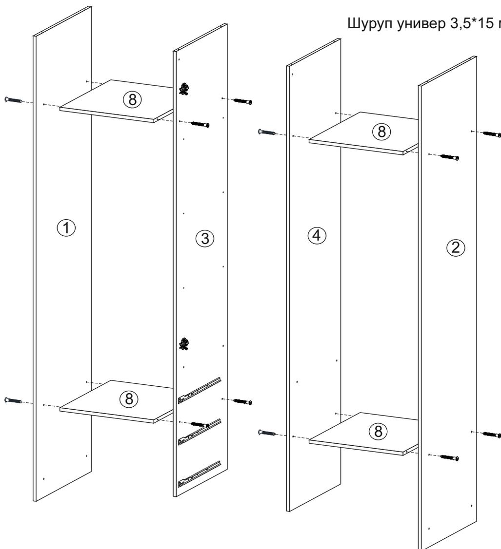
3. Боковины 1 и 3, а также 4 и 2 скрепить между собой вязками 8 при помощи еврошурупов 7\*50 мм.
