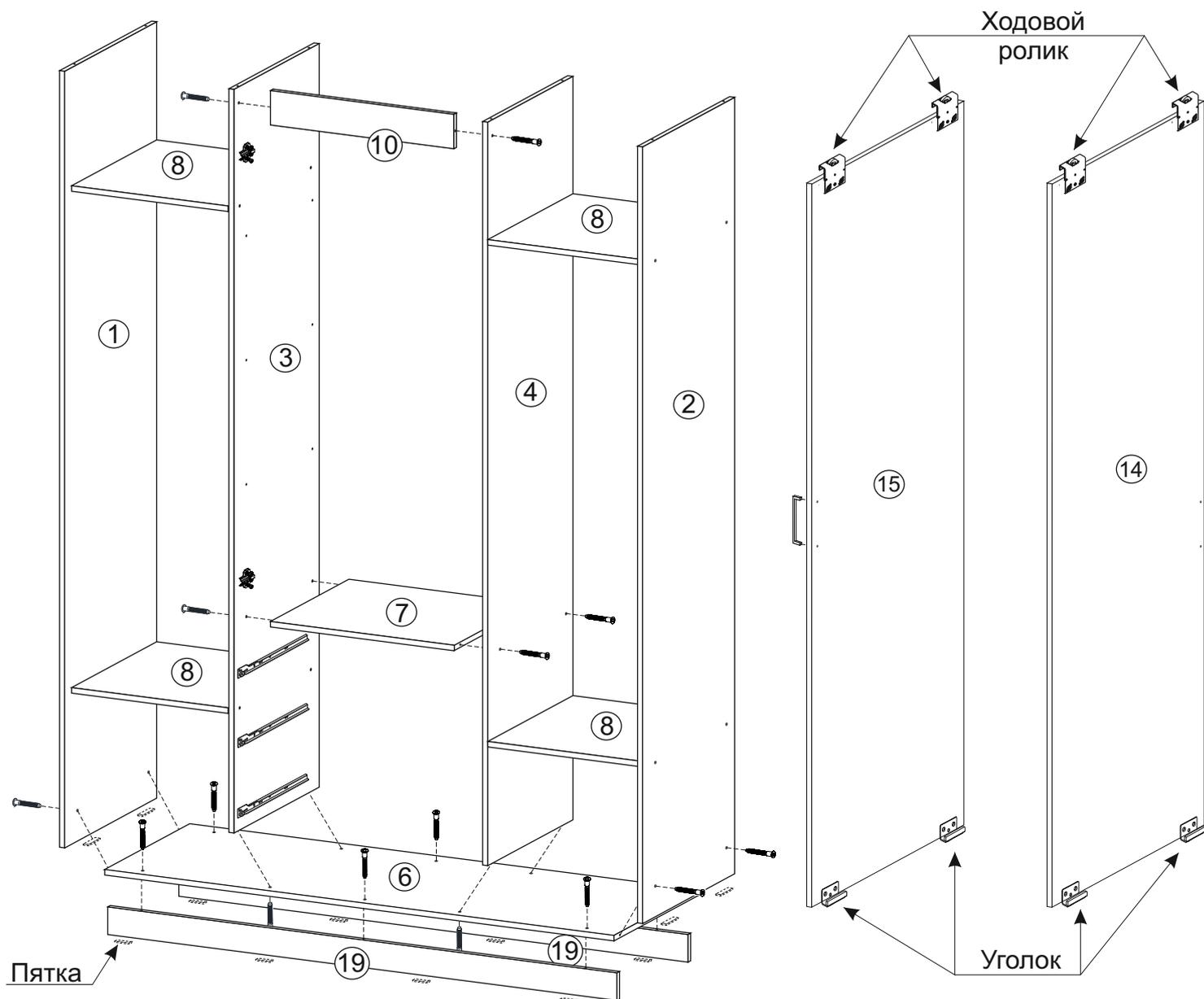
4. Собранные конструкции скрепить между собой планкой 10, вязкой 7 и 6, используя еврошурупы 7\*50 мм. Цоколя 19 соединить с вязкой 6 при помощи еврошурупов 7\*50 мм. На цоколя 19 и боковины 1 и 2 установить подпятники при помощи гвоздей (см.рис. выше).
