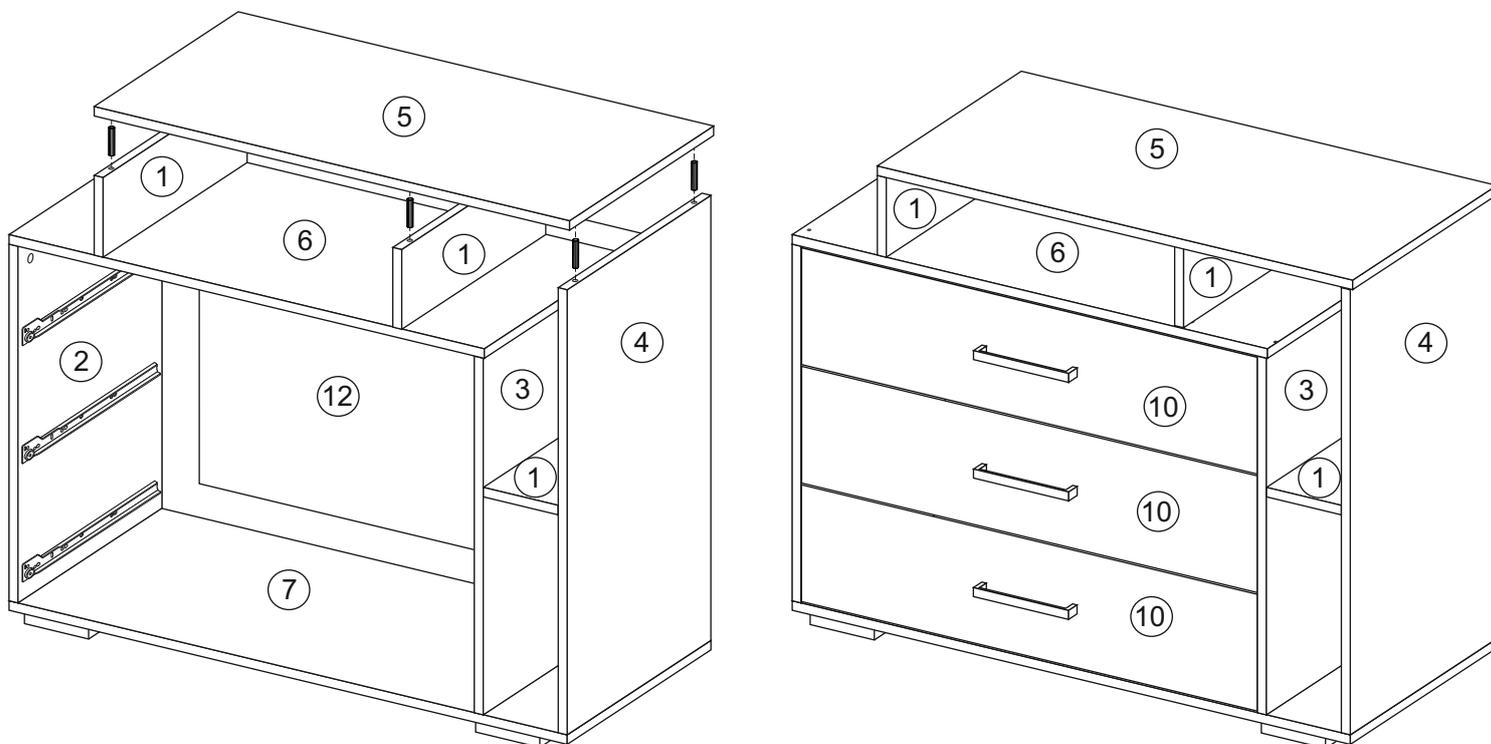
6. Крышку 5 установить на боковины 1 и 4 при помощи шкантов и клея.
