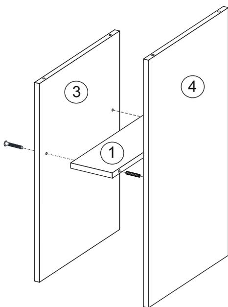
3. Подготовленную боковину 3 и боковину 4 скрепить между собой боковиной 1 при помощи шкантов, посаженных на клей, и еврошурупов 7\*50 мм и шкантов.
