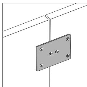
Соединительную планку установить между задниками кровати и прикроватных тумбочек при помощи шурупов 4\*16 мм
