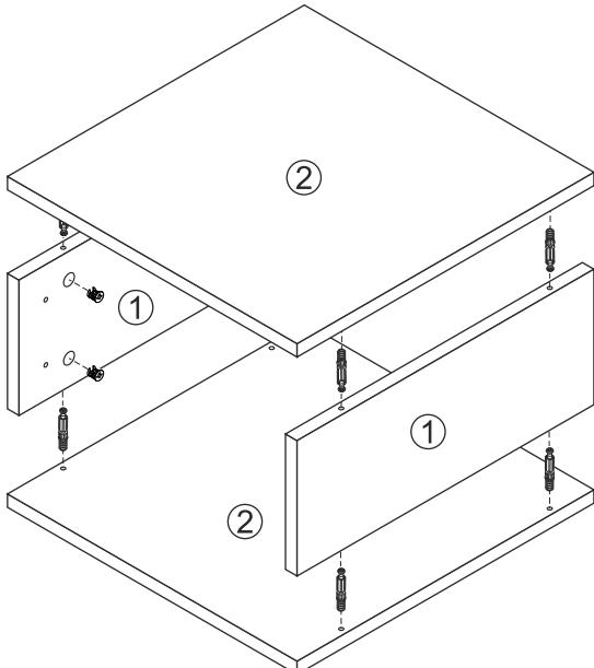
1. Сборка осуществляется горизонтально, тыльной стороной вниз. На крышки 2 в глухие отверстия установить эксцентрики. Далее крышки скрепить с боковинами 1, зафиксировав эксцентриковыми стяжками.
