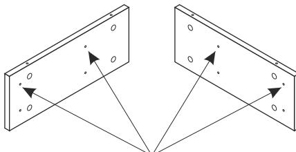
Отверстия диаметром 5 мм
